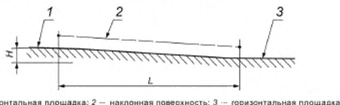
Рисунок 2 — Основные параметры пандусов наземных и подземных пешеходных дорожек
